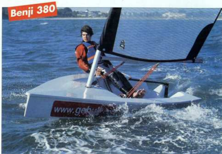
La carène du Benji a été dessinée pour naviguer avec le brion hors de l'eau. L'architecte parle d'un « shape no-nose » directement inspiré des planches de fun.
