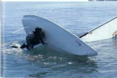
Le V visible par l'arête qui prolonge l'étrave sous la flottaison laisse vite la place à des formes très plates.
