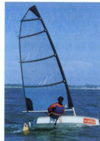
Nous disposons de la voile en film, proposée sur le modèle Ionic. Un gréement très facile à manier quand le vent se lève.
