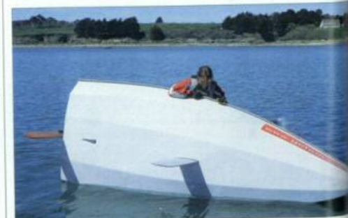
Ce dessalage volontaire (vraiment pas de vent !) dévoile bien les dessous du Benji. Dès qu'il va vite, il plane sur son bordé de fond. A propos : il se redresse facilement !
